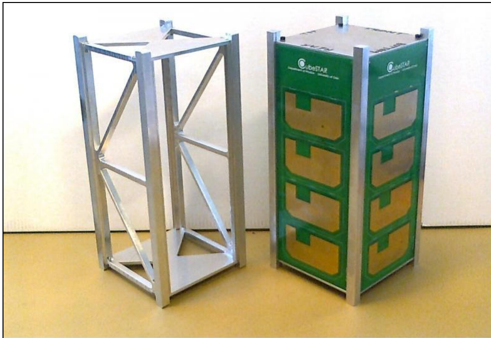
Figura 11 - Cubesat 2U e sua estrutura mecânica.
